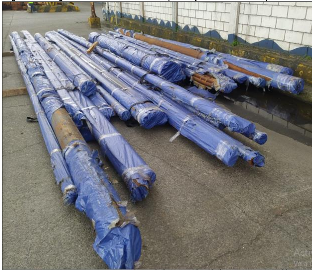
Imagen No. 10. Carga de ACEROSCOL recubierta con plástico y no almacenada en espacio con techo.
