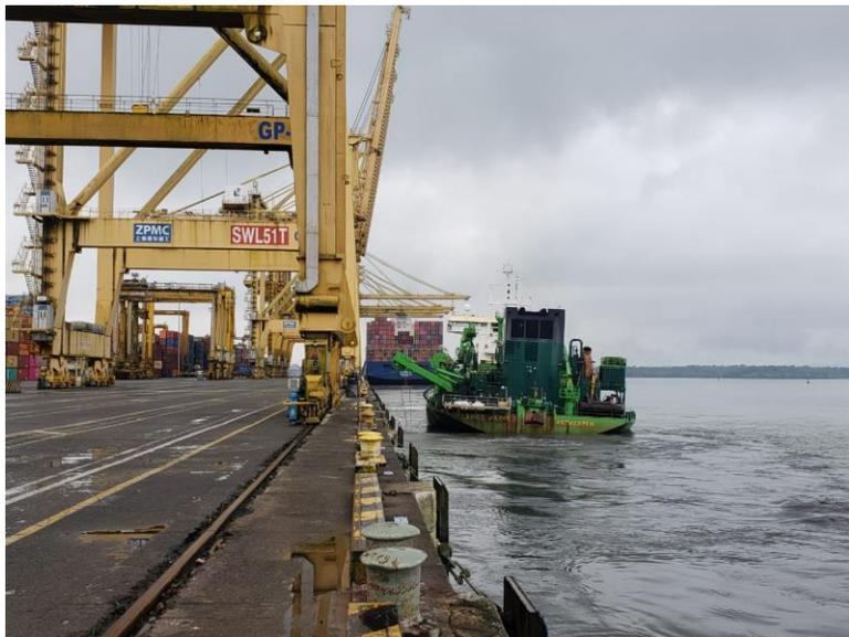
Un total de 206.000 m<sup>3</sup> de sedimentos dragados fueron trasladados mediante 68 ciclos o viajes hasta mar afuera, a una distancia de 37 kilómetros de la zona del proyecto; sitio de vertimiento final debidamente aprobado y autorizado por las
